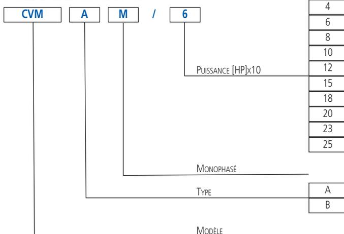
Électropompes centrifuges multicellulaires verticales en fonte.
